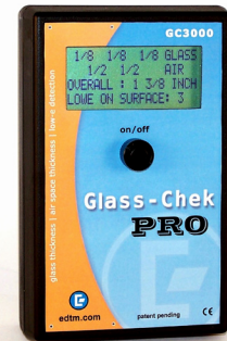
„Glass-Chek PRO“ Erkennt die Stelle und Art der Low-E-Beschichtungen, sowie Glas- und Luftraumdicke. Geeignet für einfach-, doppel- und dreifachverglaste Fenster (Modellnr. GC3000).
