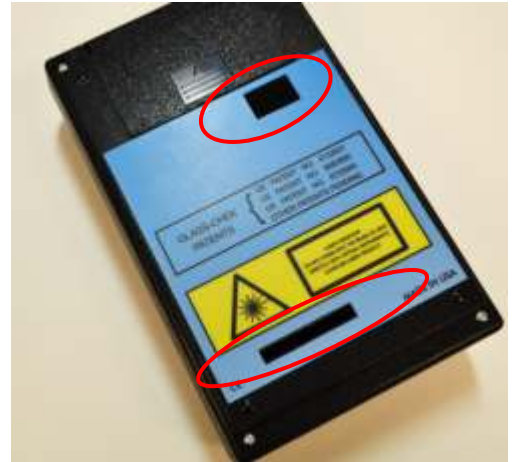
Arriba: Reverso del medidor GC3001 con las dos lentes rodeadas con círculo. Utilice solo aire comprimido limpio para limpiar las lentes.
