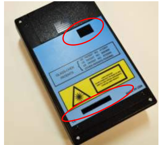
Abb. oben: Rückseite eines GC3001-Messgeräts mit zwei runden Linsen. ? Verwenden Sie saubere Druckluft, um die Linsen zu reinigen.
