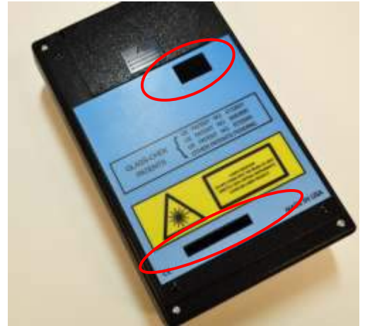
Ci-dessus : Arrière du mesureur GC3001 avec les deux lentilles entourées. Utilisez de l'air comprimé propre pour nettoyer les lentilles.
