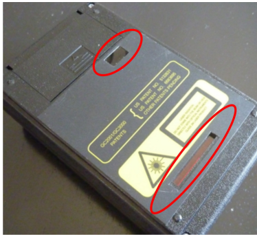
Figure 2: Arrière du mesureur GC3000 avec les deux lentilles entourées. Utilisez de l'air comprimé propre pour nettoyer les lentilles.
