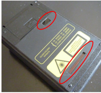
Rückseite eines GC3000-Messgeräts mit zwei runden Linsen. Verwenden Sie saubere Druckluft, um die Linsen zu reinigen.
